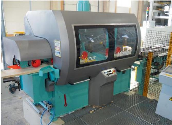
... welche die robuste X-Cut-Kappsäge von Ledinek im Anschluss auskappt
