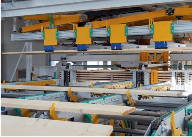
Ein Vakuumhebergerät entstapelt lagenweise das Schnittholz und legt es auf den Querförderer für die Beurteilung
