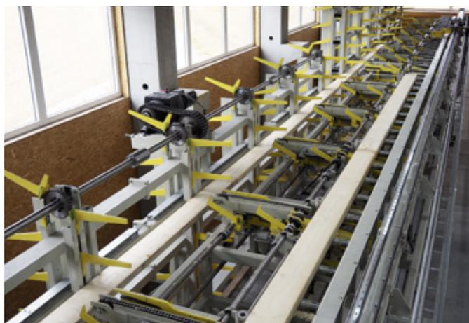
Die fertig keilgezinkten Lamellen werden auf eine Länge von 2 bis 26 m auf ±1 mm genau gekappt und mit einem Paternoster (li.) nach unten transportiert
