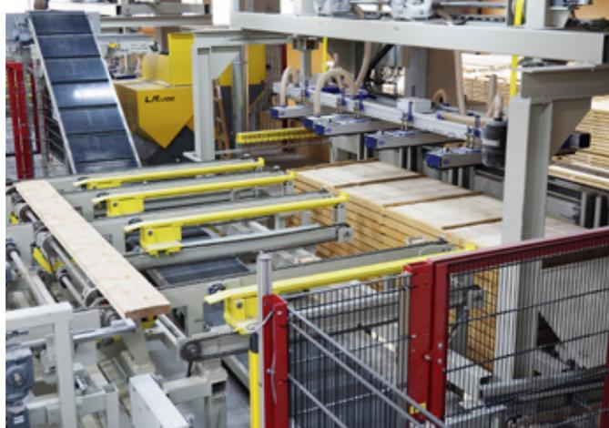
Lagenweise Entstapelung mittels eines Vakuumhebers samt automatischer Lattenentsorgung; SMB lieferte auch die komplette Mechanisierung
