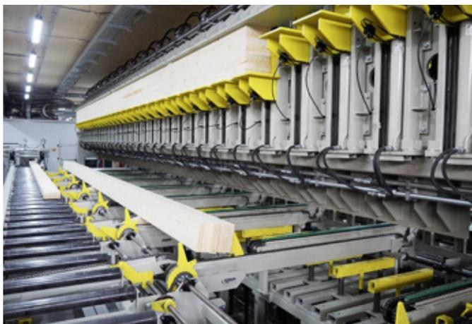
Eschelmüller Holz erzeugt jetzt auch Balkenschichtholz – im Bild die Rotationspresse für bis zu 16 m lange Leimbinder
