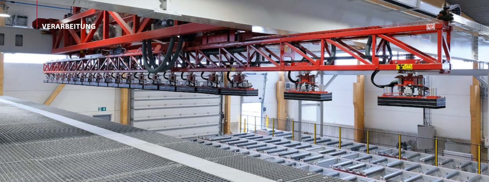
Kommissionierung: Ein Vakuumkran kann einzelne Binder zusammenstellen
