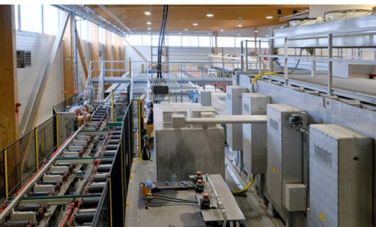
Presslinie: KVH kann links von der Presse über einen Bypass vorbeigeführt werden
