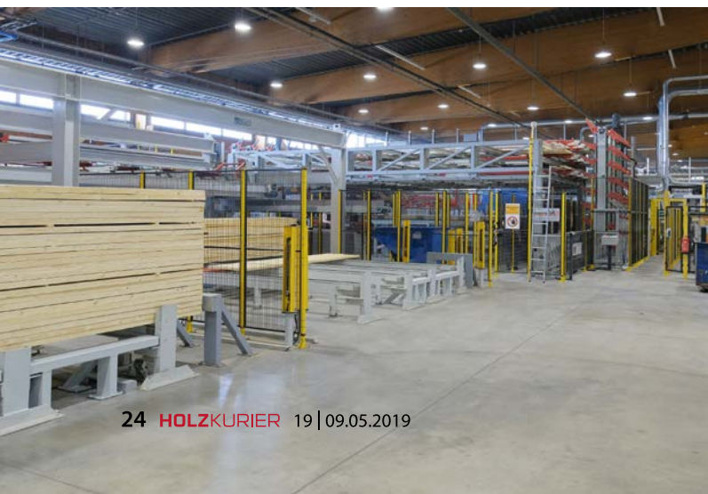
Materialaufgabe: Zwei Aufgabestationen werden mit Schnittholzpaketen beschickt
