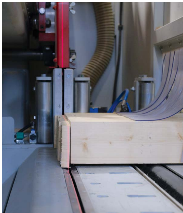
Ablängen der fertigen Binder auch im Mehrfachschnitt
