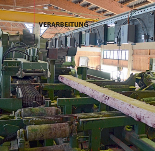
Vor dem Nachschnitt wird das Model vollflächig vermessen
