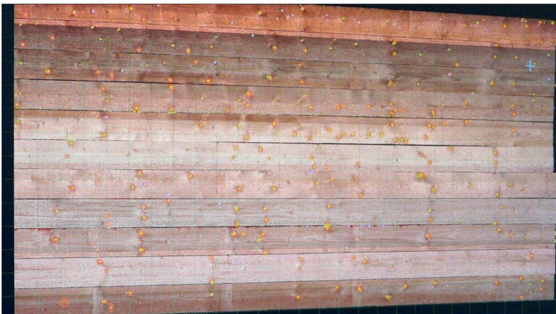
Eine vom Scanner erfasste Bretterlage mit allen Holzmerkmalen. Die gelben Punkte sind Fehlstellen, die bearbeitet werden. Das erfasste Datenvolumen dieser Lage beträgt etwa 25 GByte. Gespeichert werden die Bilder in geringerer Auflösung
