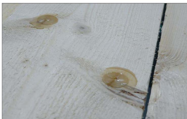
Rohhobler nach der Astkosmetik: Flügeläste im Kantenbereich werden mit Schmelzkleber soweit fixiert, dass der Ast beim Hobeln der Kante stabil bleibt
