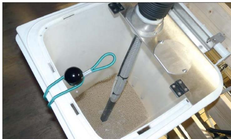
Vorratsbehälter für Schmelzkleber-Granulat. Das Granulat ist auf den speziellen Verwendungszweck bei Eisenring abgestimmt
