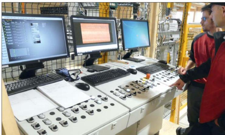
Zentrale Bedieneinheit für Scanner, Kosmetikanlage und Mechanisierung mit dazugehöriger Prozessvisualisierung
