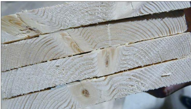
Hierum geht es: das Ausfüllen von Astrissen und das Fixieren durchgehender oder loser Äste bei Rohhoblern im Dickenbereich von 15 bis 75 mm
