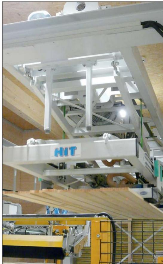
Kombiniertes Stapel- und Abstapelungsportal (hier bei der Entstapelung) mit Bürstenaggregat (gelb, unten)
