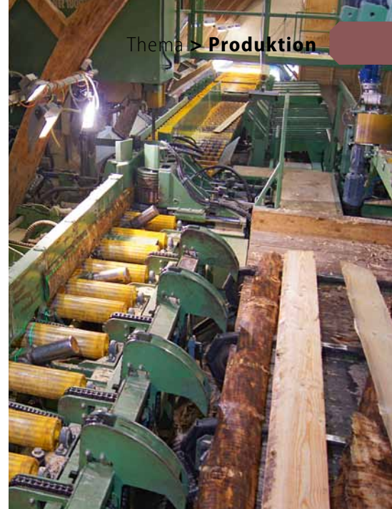
Die viertelkreisförmigen Kettenförderer platzieren die Hölzer gleich richtig
