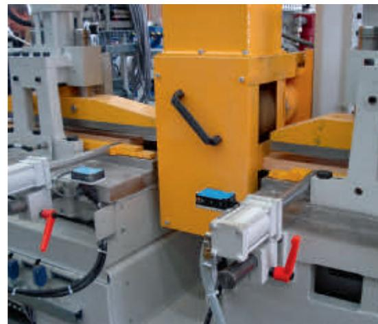
**SMB-Keilzinke mit Clou:** Fasst ausrissfrei arbeitet diese Kompaktanlage bei einem österreichischen Holzverarbeiter – dank ihrer vier Spindeln
