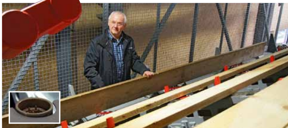
Maschinenbauer Josef Hanses am Arbeitsplatz des Sortiermannes, der über zwei Reißleinen den Weg des Holzes bestimmt – das kleine Bild zeigt den Feuchtemesser, der von unten nach oben drückt
