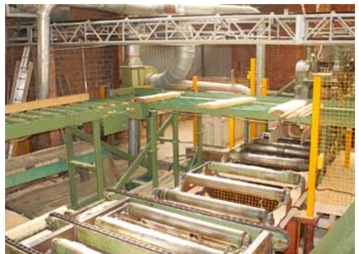
Die fertig gesägten Palettenbretter werden über eine Quertransport-Anlage über dem Gatterrollengang zur Stapelung gebracht
