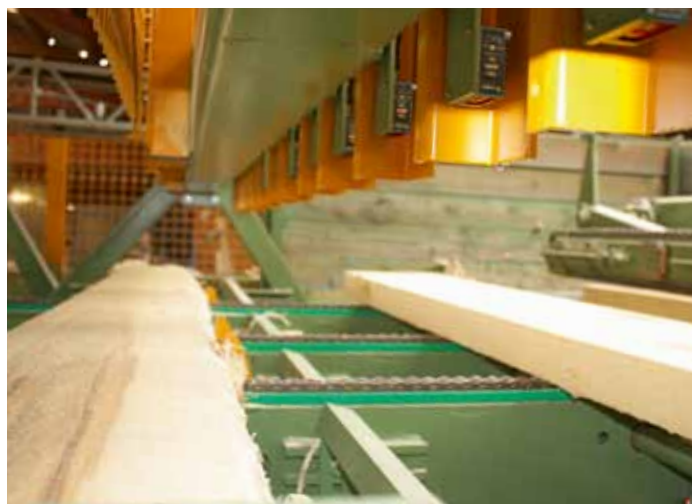
In 25 cm-Schritten sind 13 Laser angeordnet, welche die Ware von oben vermessen und dabei Breite sowie Stärke ermitteln
