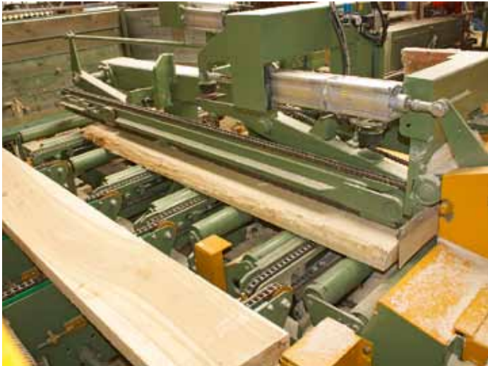
Die Model werden im Einzugsbereich vor dem Besäumer entsprechend der Optimierung positioniert
