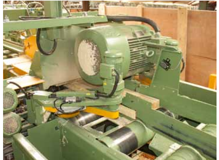
Ein automatischer Spreißelabscheider separiert hinter dem ASM 200 die Gutware
