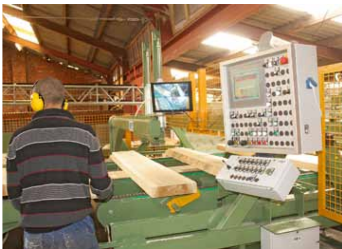
Einzugstisch vor dem Besäumer ASM 200: Der Bediener überwacht die Anlage und beurteilt die Ware
