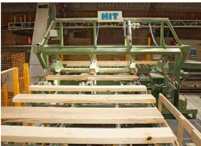
Saubere Schnittware: Die besäumten Modeln gelangen Stück für Stück zur Mehrfachablängsäge von H.I.T.
