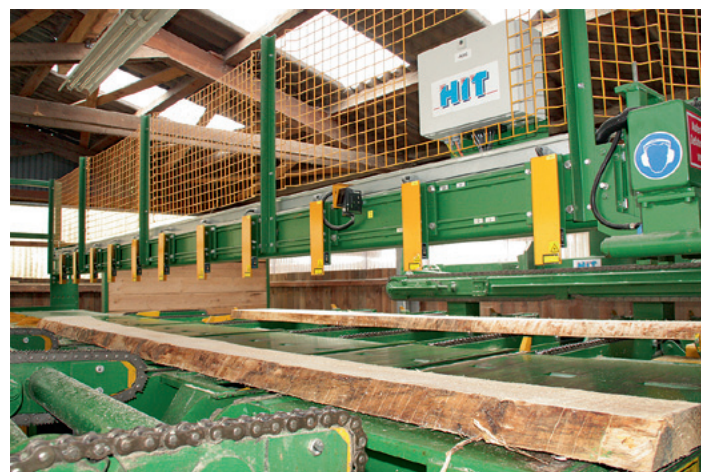
Vermessung von oben: Laser in 50 cm-Schritten ermitteln den optimalen Einschnitt der Schnittware
