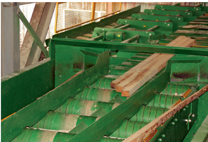
ASM 200 trennt bis zu dreistielig variabel auf, ein automatischer Abscheider separiert im Auslauf die Spreißel
