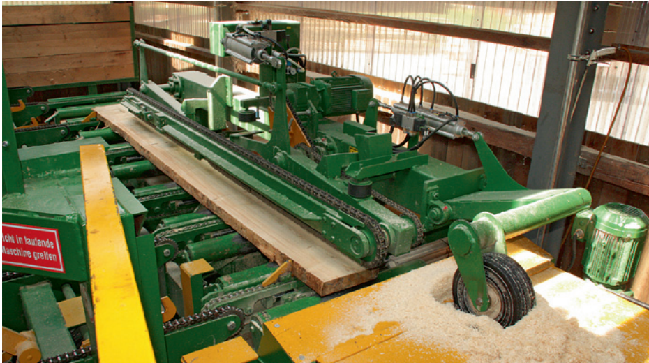
Einzugstisch: Bretter und Bohlen werden automatisch ausgerichtet und per Kettenantrieb gefördert
