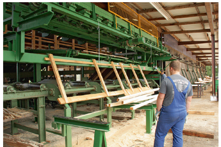
Einfache Stapelung der Ware per Hand, die zukünftige Anbindung einer Quersortieranlage ist möglich
