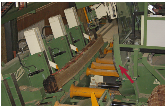
Optimaler Halt des Stammes am Blockwagen mit bis zu vier Spannanzgen, der schräge Spaner kann fast komplett unter die Kabine gefahren werden
