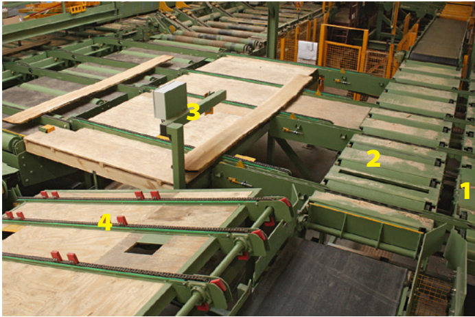
Verknüpft: 1 und 2 Rollenbahn hinter Bandsäge zu Etagen, 3 Quertransport Richtung Blockwaren-Stapelung, 4 Rücklauf von der KSM 200
