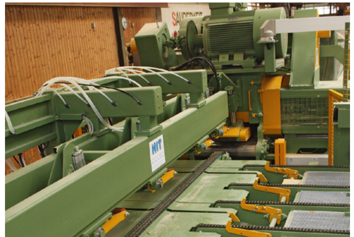
Einzugstisch in den KSM 200 von H.I.T. mit Kettenbett und Druckrollen
