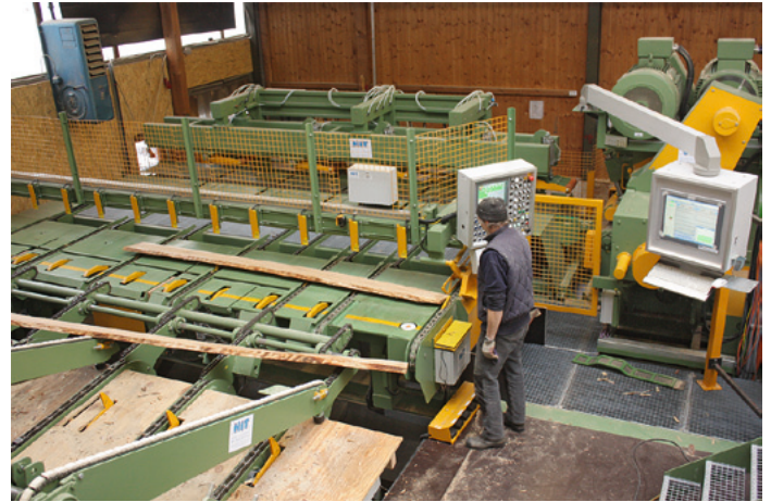
Etagenspeicher, Beurteilung, Querkappung und Vermessung vor dem KSM 200
