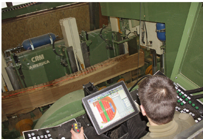
Guter Blick des Bediener auf die Schnittfläche , am Bildschirm werden die Schnittstärken angezeigt und per „Drag-and-Drop“ verändert
