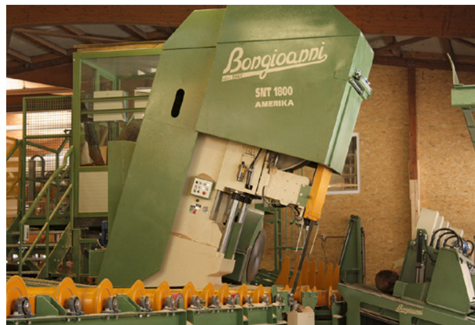
Schräge Bandsäge SNT 1800 Amerika ermöglicht ein schonendes Abgleiten der geschnittenen Ware und optimales Handling
