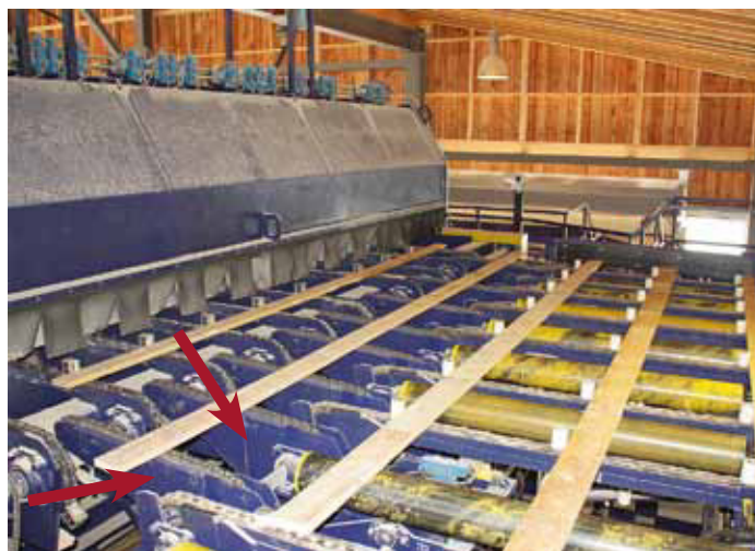
Mit bis zu elf Sägen kann die Ware im Trimmer gekappt werden, mittels Klappen (s. Pfeil) wird die Kürzungsware separiert
