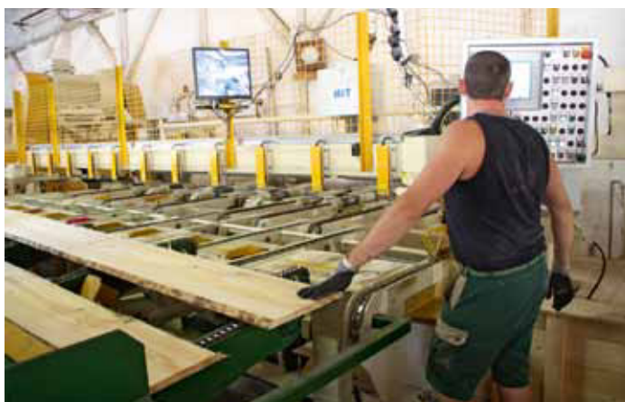
Beurteilung vor der Besäumanlage sowie Vermessung vor dem Einzug
