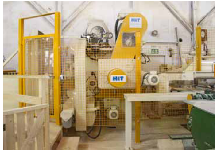
Neuer Besäumer schneidet bei Liechtenstein Holztreff Haupt- und Seitenware bis 200 mm Höhe sowie Längen von 3 bis 6 m
