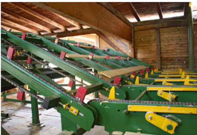
Quertransport der besäumten Ware und Vereinzelung in Richtung bestehender Sortieranlage
