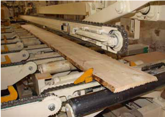
Einzug vor dem KSM 200: Ware liegt auf Rollengang, der Antrieb erfolgt von oben über Kettenförderer
