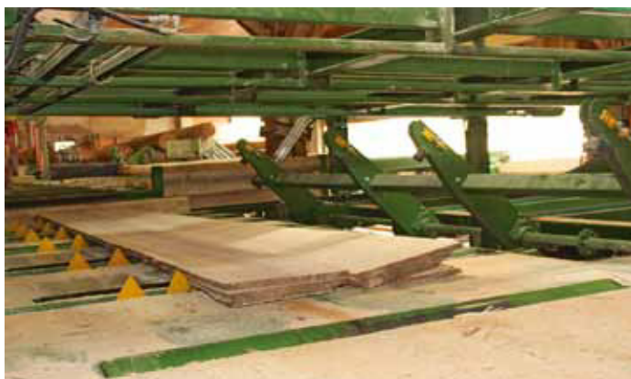
Seitenware über Klappe nach unten, Hauptware läuft darüber in Puffer
