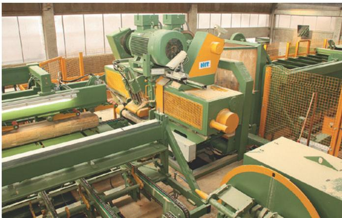
**Die KSM bewerkstelligt** Schnitthöhen bis maximal 245 mm mit zwei 132 kW starken Motoren
