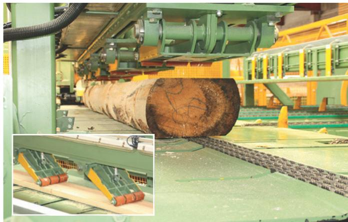
**Sicherer Transport der Schnittware** mit einem stark dimensionierten Kettenbett unten sowie Antriebsrollen oben (kl. Bild)
