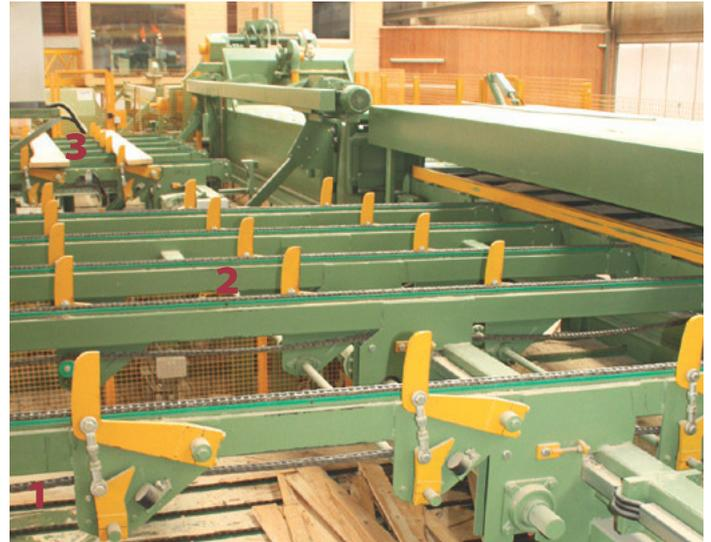
**Mechanisierung hinter der KSM:** Seitenware fällt auf Querförderer nach unten in Richtung Besäumer (1); Halbhölzer werden zur Kreissäge zurückgeschleust (2); Ware von der Bandsäge gelangt über einen Lift auf das Niveau der Nachschnittsäge (3)
