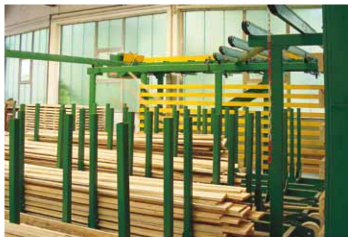
Per Schwerkraft: Der Sortierer trennt Brettware in sechs verschiedene Längengruppen ab
