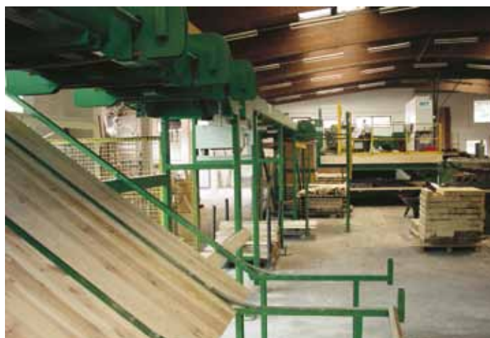
Extra lang: Der Längsförderer mit Pufferfunktion trennt Leisten (hinten) und Hauptware (vorne) ab
