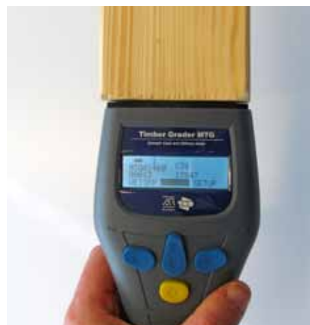
Timber Grader MTG: Handgerät für Festigkeitssortierung von Brookhuis
