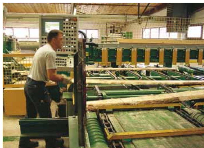
Bedienungsfreundlich: Laser übernehmen die Vermessung von Haupt- und Seitenware in der Vereinzelung
