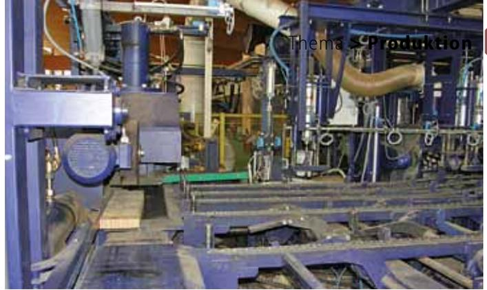
**Keilzinkung (rechts)** und Zuführung zur Presse (links)
