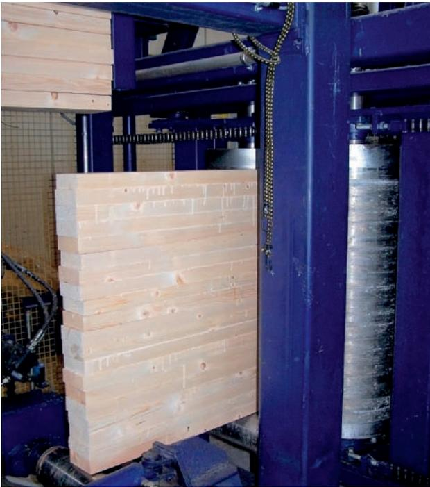
**Ein verleimter Stapel von Brettschichtholz wird in die Trocknungsanlage gefahren. Das genaue Aufmaß wird während des Einschubvorgangs von der Bildverarbeitung erfasst.**
